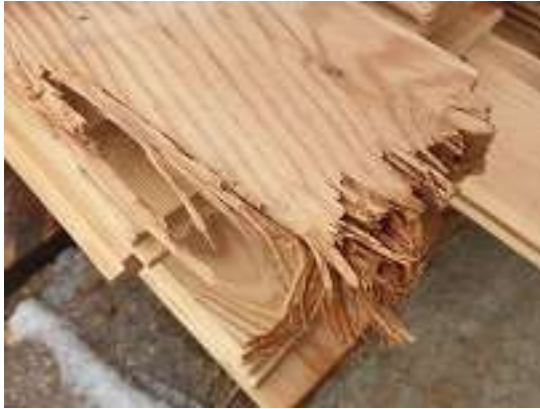
pęknięcia na końcach
